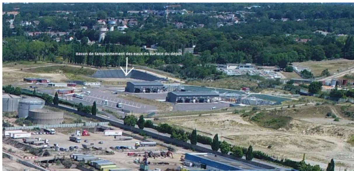
Figure 56 : bassin de tamponnement des eaux de surface provenant du dépôt du Milthuit
